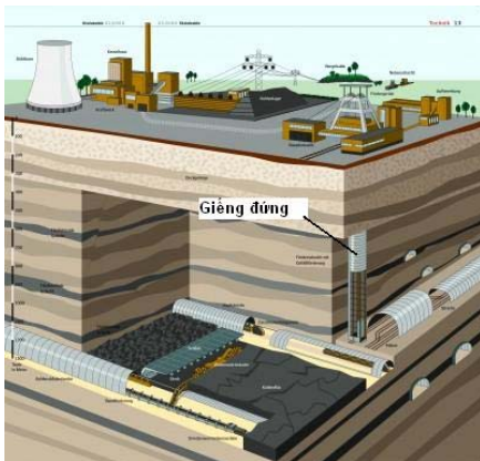
Giếng đứng trong hệ thống đường lò khai thác than hầm lò
